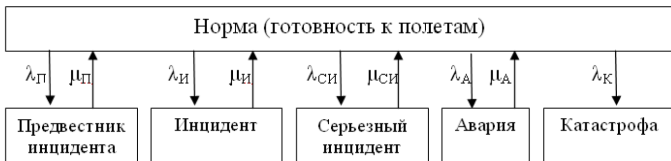
Рисунок 2.11 – Граф состояний системы (ВС).
